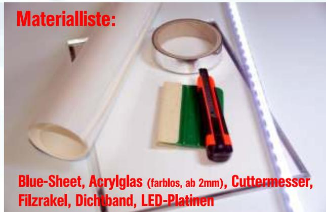
Blue-Sheet, Acrylglas (farblos, ab 2mm), Cuttermesser, Filzrakel, Dichtband, LED-Platinen
