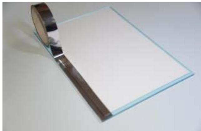
4. Dichtband rundum kleben
